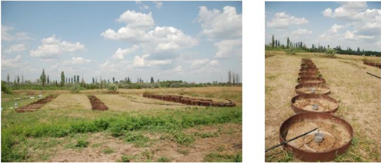
Рис. 1. Експериментальні лізиметри для визначення оптимальної стратиграфії техноземів на біоекологічному стаціонарі Дніпропетровського державного аграрно-екологічного університету (м. Покров, Дніпропетровська обл., Україна)
